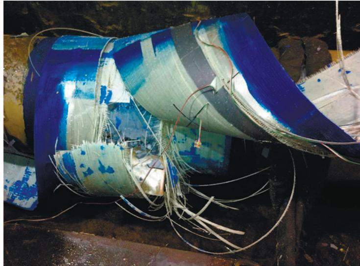
**Зображення 14 – Вихід з ладу ремонтаного зразка WrapMaster PCC-2 (PermaWrap™ з обмотки)**
